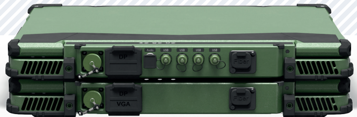
Vor Wind und Wetter geschützte Schnittstellen (Ansicht der Rückseite von Variante SDIP 27 Level A (oben), Zone 1 (unten))
